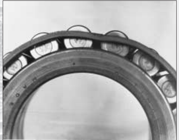
Cage damage. Déterioration de la cage au montage. Käfigschaden. Danneggiamiento della gabbia. Dañado de la jaula.
