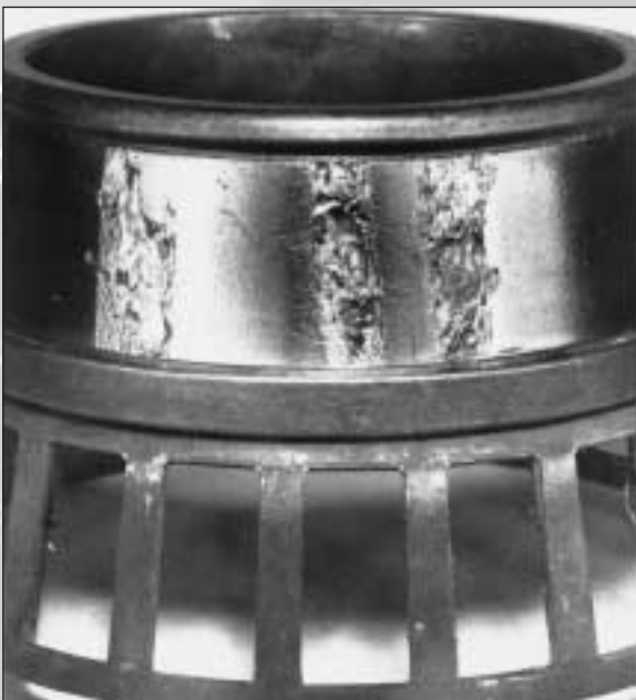
Spalling. Ecaillage dû à la présence d'eau. Aufwölbungen.
