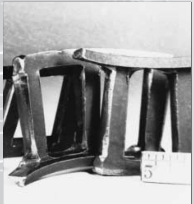
Cage breakage. Rupture de la cage en fonctionnement. Käfigbruch. Rottura della gabbia. Rotura de la jaula.
